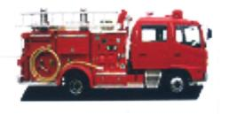
※ 消防車両に水を積載しており、火災現場到着後すぐに消火活動が出来る消防車両
